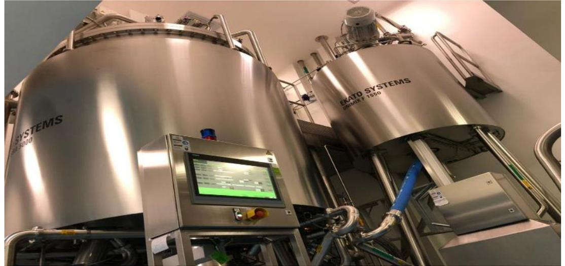
Reactor de Producción Ekato (**Línea de Manufactura Semi-Sólidos**)
