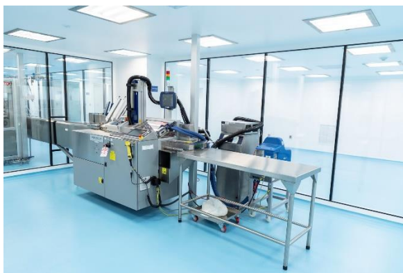
NordenPAC 702 Equipo de llenado para línea de producción de Semi-sólidos
